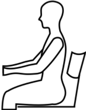
fig. 2 Posizione ortostatica del busto. Forma e posizionamento sbagliato dello schienale.
